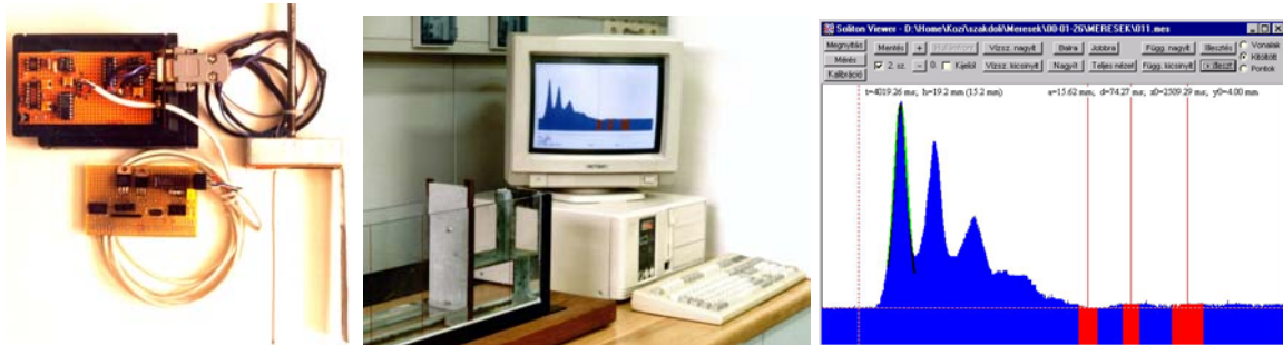
3.ábra: Szolitonhullámok vizsgálata [14] (szenzor+interfész, kísérleti összeállítás, kiértékelő program képernyőrajza).
