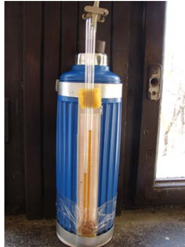
2. ábra. Házilag elkészíthető barometrikus nyomásmérő
